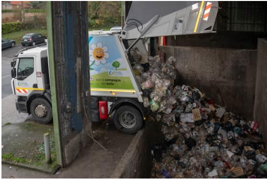
Déchets non recyclables stockés dans une fosse avant leur transfert pour l'enfouissement
